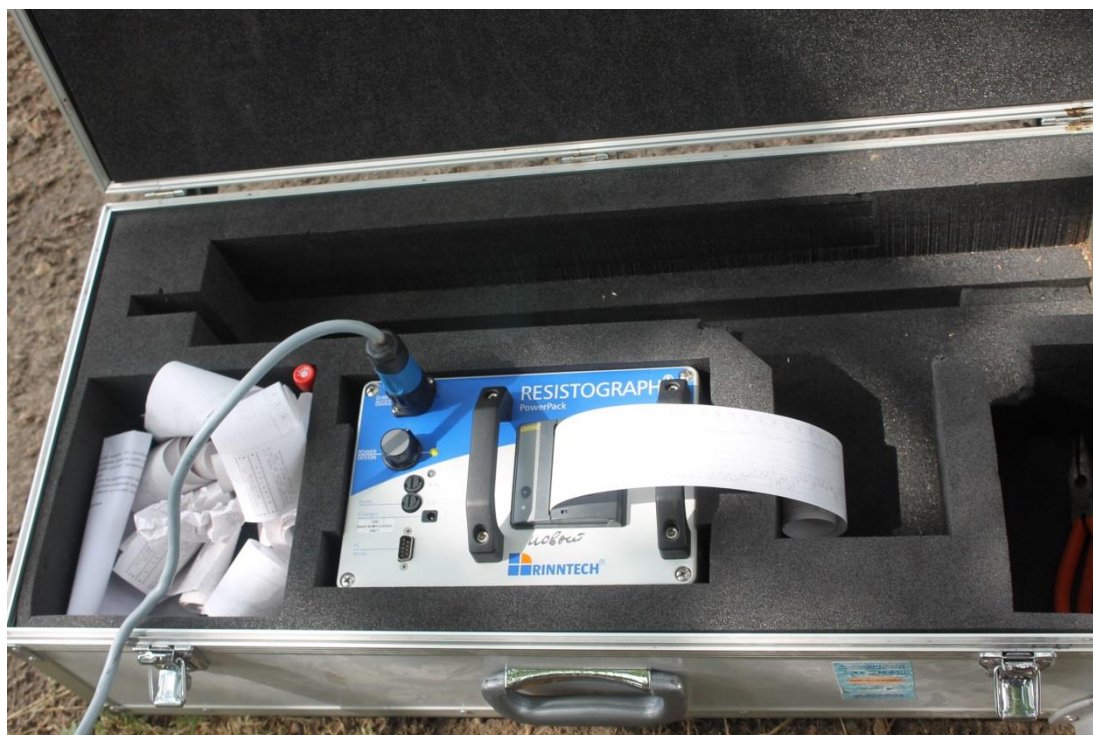
Резистограф для определения внутреннего состояния ствола
